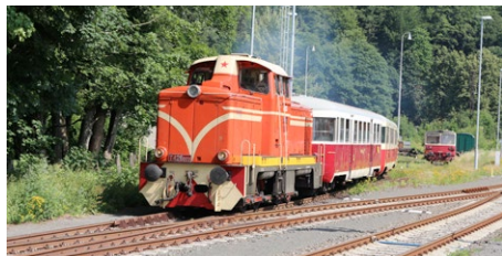
Lokomotiva se speciálním Abtovým ozubnicovým systémem, který je použit na ozubnicové trati z Tanvaldu do Harrachova. Foto: Aneta Rolníková.
